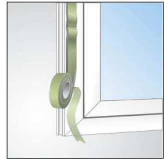
Bild 2: Stumpfstoß bei der Fenstermontage
