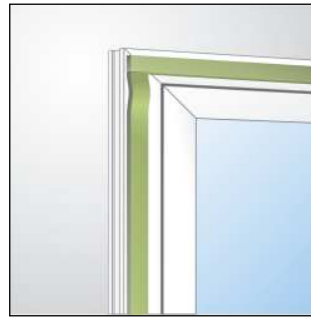
Bild 1: Eckauslegung bei der Fenstermontage
