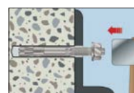
3. Svorníkovú kotvu prevliecť cez upevňovaný stavebný diel a zatlačiť
