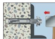
3. Svorníkovú kotvu prestrčiť cez pripevňovaný stavebný diel a zatĺcť
